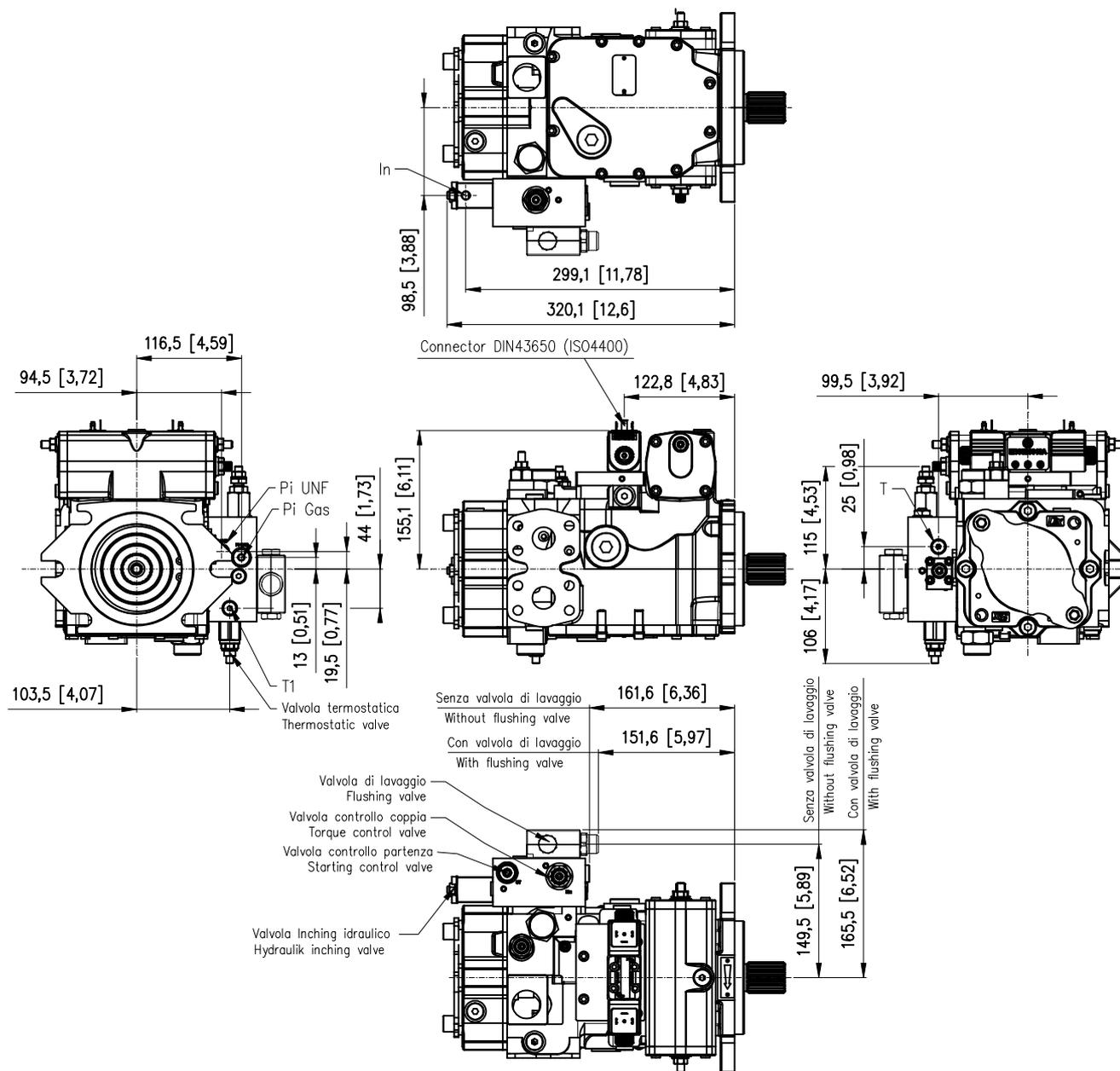
Pi Gas: Attacco manometro pressione pilotaggio / Piloting pressure gauge port - 1/4 G (BSPP) (ISO)
