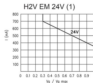
**Sovralimentazione del regolatore:** Quando è necessario variare la cilindrata del motore con una pressione di esercizio inferiore ai 40 bar si deve sovralimentare il regolatore mediante un circuito ausiliario.
