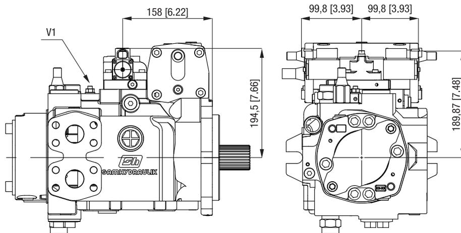
V1: Strozzatore variabile / Adjustable throttle valve
