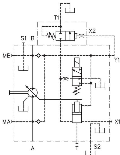
La cilindrata del motore é variabile agendo sul volantino esterno. La posizione standard del regolatore é (1) ( $Vg_{max} \rightarrow Vg_{min}$ ) ma la posizione (2) ( $Vg_{min} \rightarrow Vg_{max}$ ) é disponibile a richiesta.
