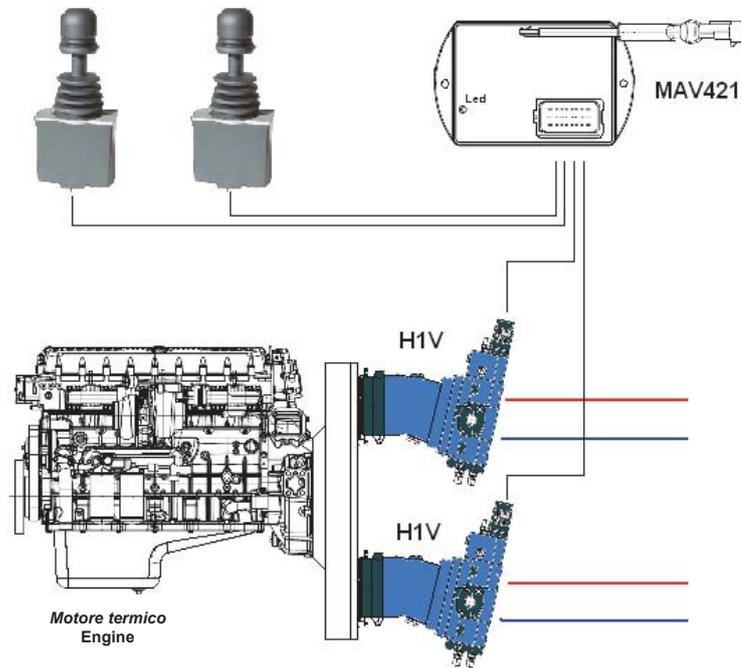
**Modalità 5 = Controllo di una pompa circuito chiuso e di uno o due motori in sequenza**
