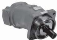
*Le pompe della serie H1C sono del tipo a pistoni assiali, a corpo inclinato, a cilindrata fissa, per circuito aperto. Le pompe H1C sono disponibili sia in versione ISO che SAE.*
