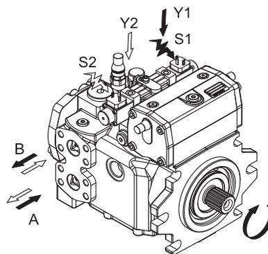
Il comando "AUTOMOTIVE" è tipicamente usato in trasmissioni idrostatiche con pompe in circuito chiuso.
