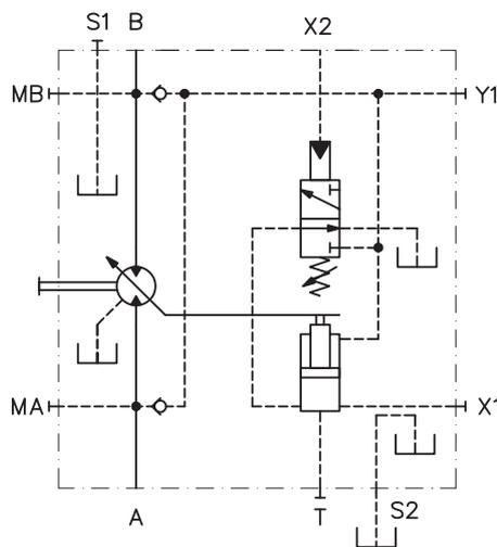
**Sovralimentazione del regolatore:** Quando è necessario variare la cilindrata del motore con una pressione di esercizio inferiore ai 40 bar si deve sovralimentare il regolatore mediante un circuito ausiliario.
