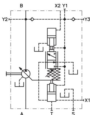
**Sovralimentazione del regolatore:** Quando è necessario variare la cilindrata della pompa con una pressione di esercizio inferiore ai 40 bar si deve sovralimentare il regolatore mediante un circuito ausiliario attraverso l'attacco Y3.
