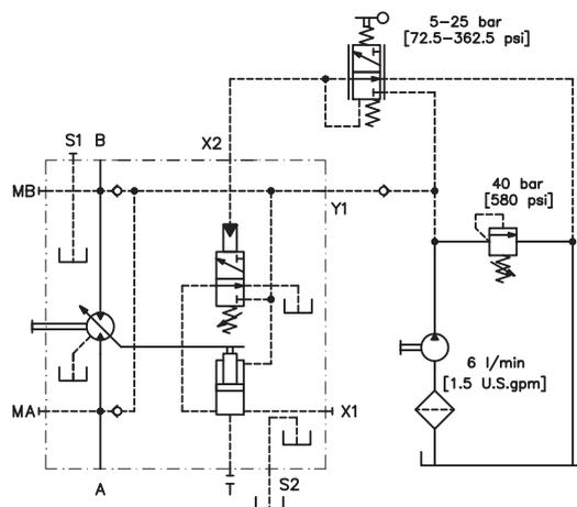
**NOTA:** Il circuito qui riprodotto ha il solo scopo di illustrare le connessioni da effettuare per la realizzazione di un circuito di sovralimentazione.
