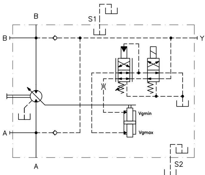
La relazione tra il senso di rotazione dell'albero del motore SH7VR e la direzione del flusso è illustrata in figura
