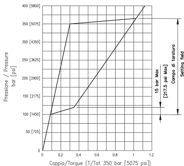
Il regolatore "PE100" consente la variazione della cilindrata in un campo maggiore di pressione rispetto al regolatore "PE". L'aumento del campo di pressione per la variazione dalla  $V_{g_{min}}$  alla  $V_{g_{max}}$  consente un comportamento più dolce e graduale del motore durante la variazione. Il regolatore "PE100" consente la variazione della cilindrata con campi di pressione indicati in tabella.
