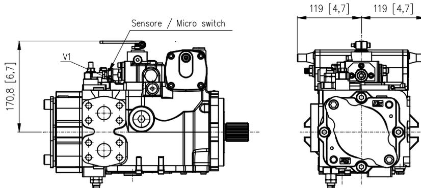
V1: Strozzatore variabile / Adjustable throttle valve
