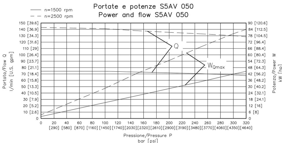
*I diagrammi sono rappresentativi della media della normale produzione della Brevini Fluid Power. Le prove sono state eseguite con olio minerale ISO VG 46 a 50°C.*
