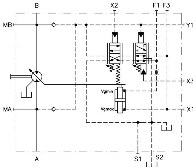
La relazione tra il senso di rotazione dell'albero del motore SH7V e la direzione del flusso è illustrata in figura
