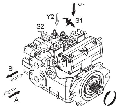
Il comando "AUTOMOTIVE" è tipicamente usato in trasmissioni idrostatiche con pompe in circuito chiuso.
