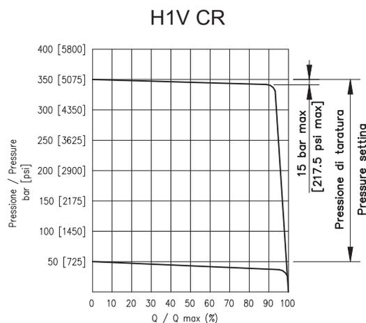
Una pressione ausiliaria esterna agisce sulla bocca X2 come segnale di pilotaggio. Variando tale pressione il pilota varia la propria posizione, comprimendo la molla di retroazione.
