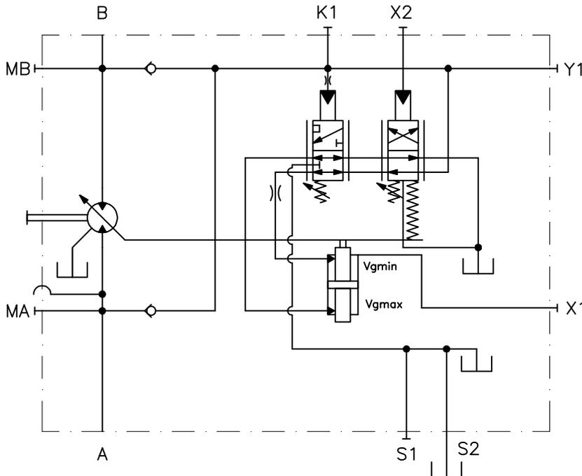
La relazione tra il senso di rotazione dell'albero del motore SH7V e la direzione del flusso è illustrata in figura
