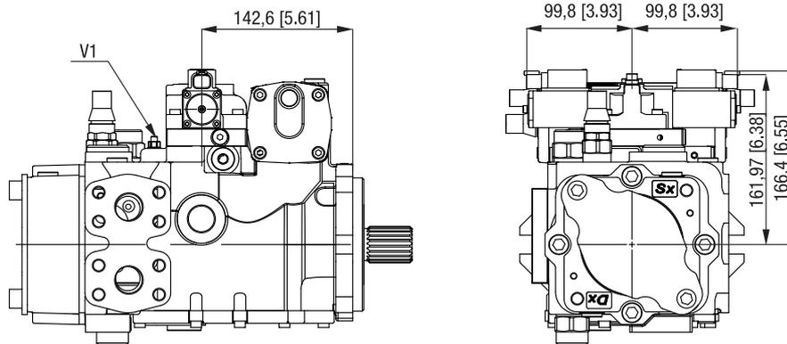
V1: Strozzatore variabile / Adjustable throttle valve
