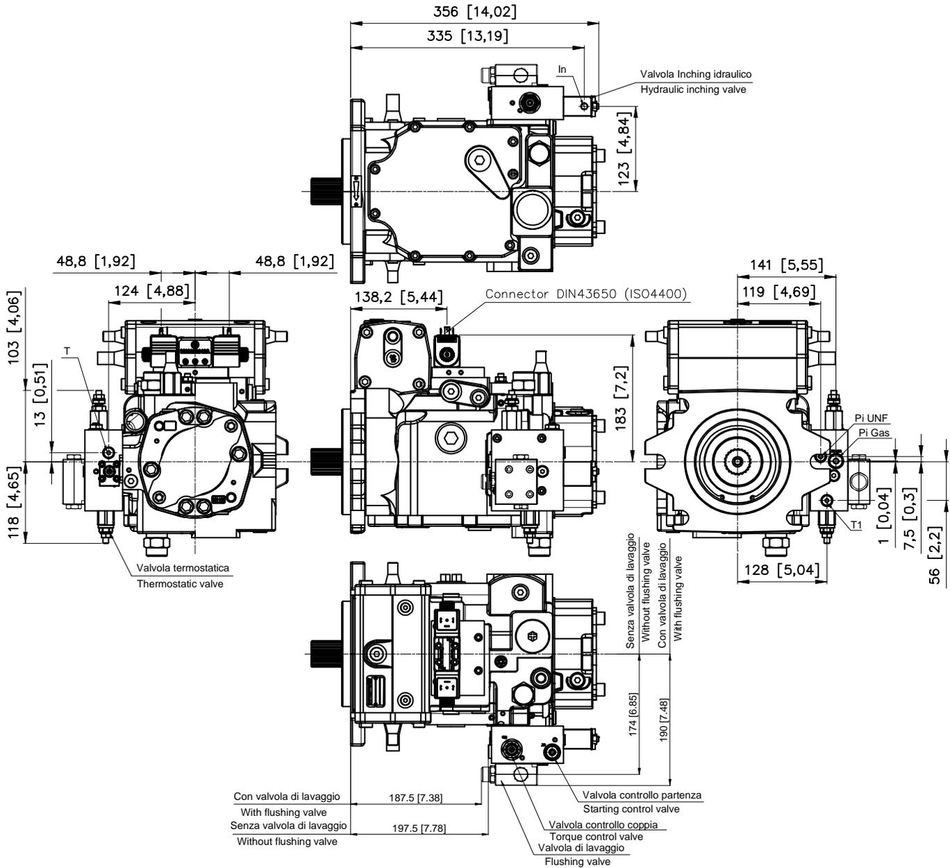
Pi Gas: Attacco manometro pressione pilotaggio / Piloting pressure gauge port - 1/4 G (BSPP) (ISO)
