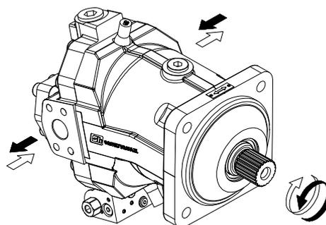
Il regolatore elettromagnetico a due posizioni permette di regolare la cilindrata del motore tra  $V_{g_{max}}$  e  $V_{g_{min}}$  intervenendo sull'alimentazione di un magnete ON/OFF. La mancanza della molla di retroazione consente di ottenere solo le due cilindrature estreme ( $V_{g_{max}}$  e  $V_{g_{min}}$ ).
