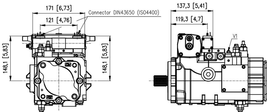
V1: Strozzatore variabile / Adjustable throttle valve
