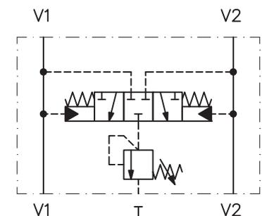
VSC20L - Valvole di scambio con portata ~ 20 l/min a 21 bar (in linea).
