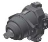
*I motori della serie SH7VR sono del tipo a pistoni assiali, a corpo inclinato, a cilindrata variabile, adatti all'utilizzo sia in circuito aperto che in circuito chiuso. I motori della serie SH7VR sono progettati principalmente per abbinarsi ai riduttori di velocità, come ad esempio i riduttori ruota o i riduttori per argani. Disponibili valvole flangiabili sia per circuito aperto che circuito chiuso.*
