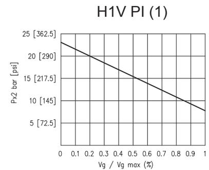
**Sovralimentazione del regolatore:** Quando è necessario variare la cilindrata della pompa con una pressione di esercizio inferiore ai 40 bar si deve sovralimentare il regolatore mediante un circuito ausiliario attraverso l'attacco Y3.
