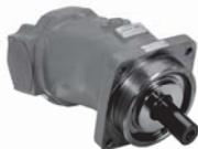
*I motori della serie H1C sono del tipo a pistoni assiali, a corpo inclinato, a cilindrata fissa, per circuito aperto o chiuso. I motori H1C sono disponibili sia in versione ISO che SAE.*
