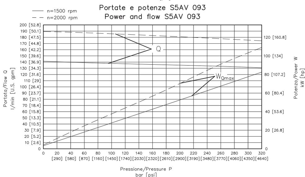
*I diagrammi sono rappresentativi della media della normale produzione della Brevini Fluid Power. Le prove sono state eseguite con olio minerale ISO VG 46 a 50°C.*
