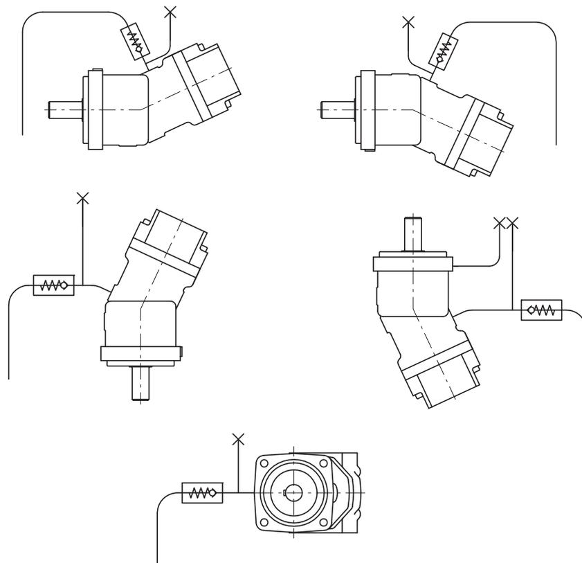
Figura 2 - Installazione sopra il serbatoio / Figure 2 - Installation above the tank
