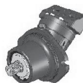
*I motori della serie SH11CR sono del tipo a pistoni assiali, a corpo inclinato, a cilindrata fissa, adatti all'utilizzo sia in circuito aperto che in circuito chiuso. I motori della serie SH11CR sono progettati principalmente per abbinarsi ai riduttori di velocità, come ad esempio i riduttori ruota o i riduttori per argani. Disponibili valvole flangiabili sia per circuito aperto che circuito chiuso.*
