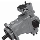
*Le pompe della serie H1V sono del tipo a pistoni assiali, a corpo inclinato, a cilindrata variabile e sono adatte all'impiego in circuito aperto. Il grande numero di regolatori danno alle pompe H1V la capacità di adattarsi alle più diverse tipologie di impianto. L'alta qualità dei materiali e dei componenti usati assicurano una lunga durata in esercizio con elevati rendimenti. Le pompe H1V sono disponibili sia in versione ISO che SAE.*
