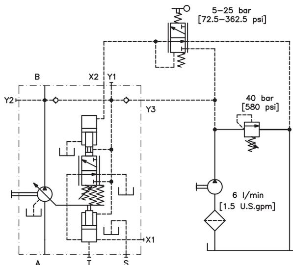
NOTA: Il circuito qui riprodotto ha il solo scopo di illustrare le connessioni da effettuare per la realizzazione di un circuito di sovralimentazione.
