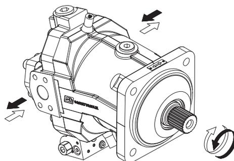
*Il regolatore elettromagnetico a due posizioni permette di regolare la cilindrata del motore tra  $V_{g_{max}}$  e  $V_{g_{min}}$  intervenendo sull'alimentazione di un magnete ON/OFF. La mancanza della molla di retroazione consente di ottenere solo le due cilindrata estreme ( $V_{g_{max}}$  e  $V_{g_{min}}$ ).*
