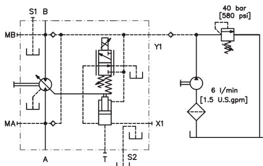
**NOTA:** Il circuito qui riprodotto ha il solo scopo di illustrare le connessioni da effettuare per la realizzazione di un circuito di sovralimentazione.
