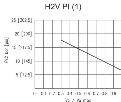
**Sovralimentazione del regolatore:** Quando è necessario variare la cilindrata del motore con una pressione di esercizio inferiore ai 40 bar si deve sovralimentare il regolatore mediante un circuito ausiliario.
