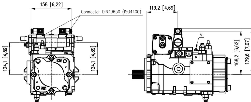
V1: Strozzatore variabile / Adjustable throttle valve
