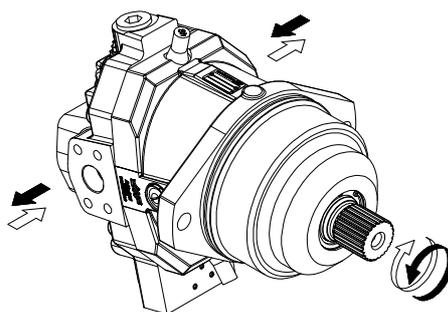
Il regolatore "ROE" consente la variazione della cilindrata in un campo maggiore di pressione rispetto al regolatore "RPE". L'aumento del campo di pressione per la variazione dalla  $V_{g_{min}}$  alla  $V_{g_{max}}$  consente un comportamento più dolce e graduale del motore durante la variazione. Il regolatore "ROE" consente la variazione della cilindrata con campi di pressione indicati in tabella.
