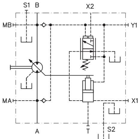
**Sovralimentazione del regolatore:** Quando è necessario variare la cilindrata del motore con una pressione di esercizio inferiore ai 40 bar si deve sovralimentare il regolatore mediante un circuito ausiliario.
