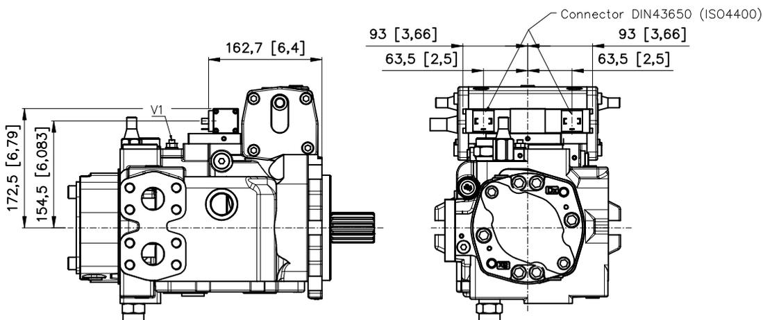
V1: Strozzatore variabile / Adjustable throttle valve
