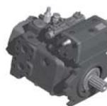
*La pompa S6CV è una pompa a pistoni assiali a piatto inclinato e cilindrata variabile per trasmissioni idrostatiche in circuito chiuso per alte pressioni. La pompa è disponibile nelle cilindrata 75 e 128 cm<sup>3</sup>/giro e con numerosi sistemi di regolazione della cilindrata. La pompa può essere fornita in versione singola o tandem e predisposta per il montaggio di gruppi ausiliari.*
