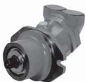
*I motori della serie H1CR sono del tipo a pistoni assiali, a corpo inclinato, a cilindrata fissa, adatti all'utilizzo sia in circuito aperto che in circuito chiuso. I motori della serie H1CR sono progettati principalmente per abbinarsi ai riduttori di velocità, come ad esempio i riduttori ruota o i riduttori per argani. Disponibili valvole flangiabili sia per circuito aperto che circuito chiuso.*
