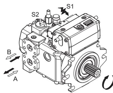
Alimentando uno dei due elettromagneti ON-OFF (standard 24V c.c. opzionale 12V c.c.), la pompa si porta alla cilindrata massima nel senso di mandata corrispondente al magnete eccitato. Togliendo l'alimentazione la pompa si porta in annullamento di portata.
