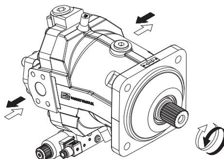
Il regolatore idraulico proporzionale consente un adeguamento continuo della cilindrata del motore proporzionalmente alla pressione di pilotaggio applicata sull'attacco X2.
