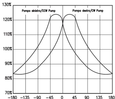
Il diagramma mostra che per determinate direzioni di carico è possibile avere incrementi di durata della vita dei cuscinetti anche del 30%. L'aumento massimo di durata dipende dalla pressione di esercizio e dalla dimensione nominale dell'unità a pistoni.
