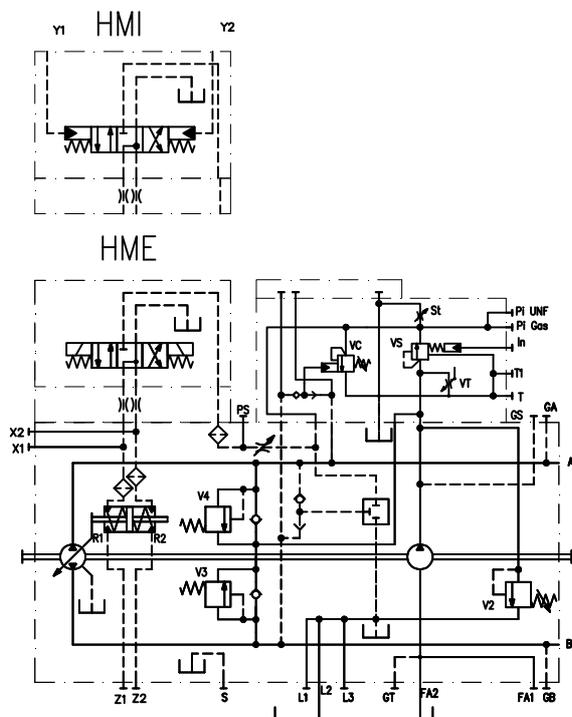
Automotive elettrico (HME)/idraulico (HMI) con Inching idraulico (IH)+Valvola di lavaggio
