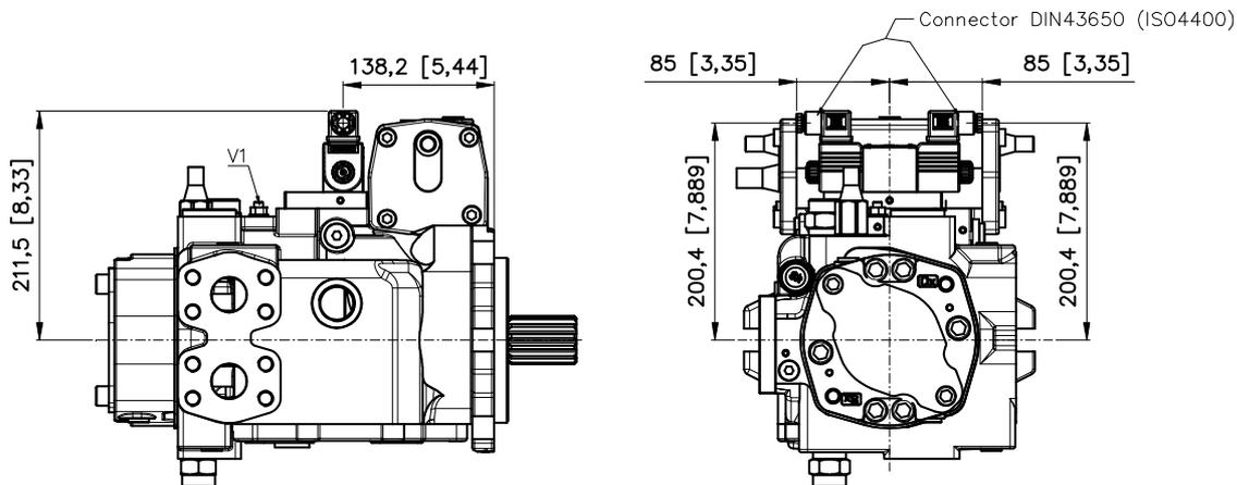
V1: Strozzatore variabile / Adjustable throttle valve
