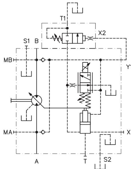
Il regolatore elettromagnetico a due posizioni permette di regolare la cilindrata del motore tra  $Vg_{max}$  e  $Vg_{min}$  intervenendo sull'alimentazione di un magnete ON/OFF. Il funzionamento è analogo all'EM, ma la mancanza della molla di retroazione consente di ottenere solo le due cilindrature estreme ( $Vg_{max}$  e  $Vg_{min}$ ).
