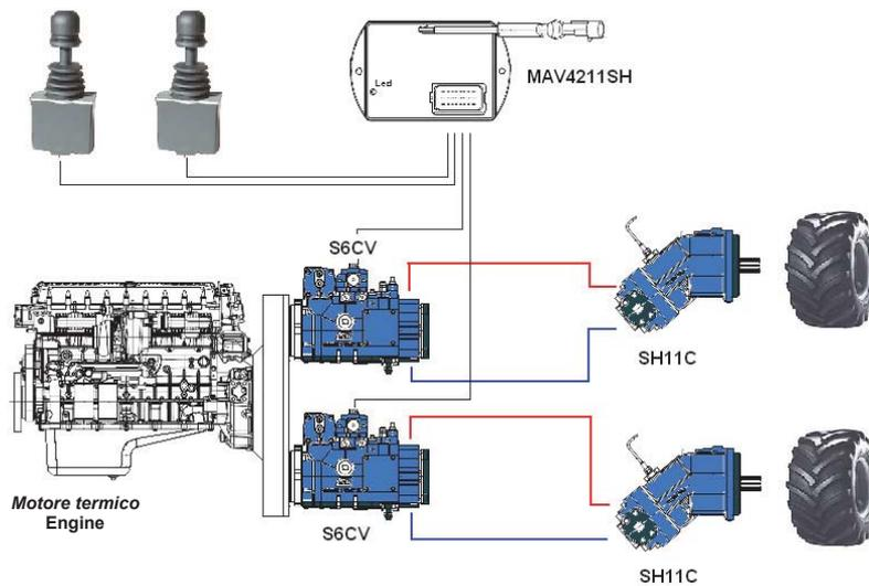
**Modalità 3 = Controllo di due pompe in circuito chiuso in collegamento tandem**
