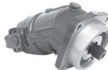
*Le pompe della serie SH11C sono del tipo a pistoni assiali, a corpo inclinato, a cilindrata fissa, per circuito aperto. Le pompe SH11C sono disponibili sia in versione ISO che SAE.*
