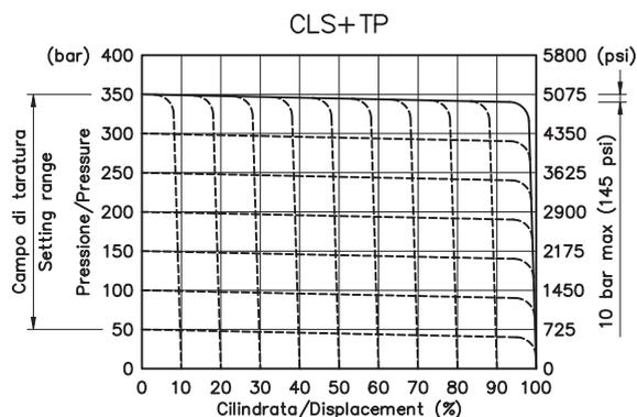
Il regolatore a potenza costante controlla la cilindrata della pompa in funzione della pressione di esercizio in modo che la potenza assorbita dalla pompa non sia mai superiore alla potenza massima fornita dal motore primo.
