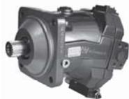
*La serie SH7V è una famiglia di motori idraulici, del tipo a pistoni assiali, a corpo inclinato, a cilindrata variabile adatti all'impiego sia in circuito aperto che in circuito chiuso.*
