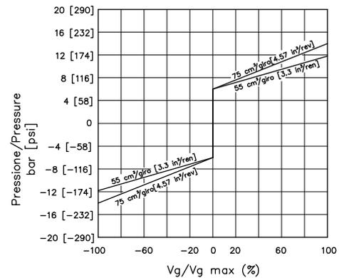
**Senso di rotazione:** Correlazione tra il senso di rotazione della pompa (visto dal lato albero) e l'azionamento del regolatore.
