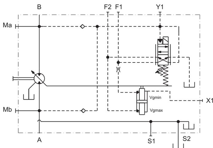
La relazione tra il senso di rotazione dell'albero del motore SH7V e la direzione del flusso è illustrata in figura
