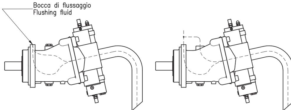
Figura 4 - Flussaggio cuscinetti / Figure 4 - Bearings flushing
