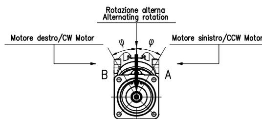
Il diagramma mostra che per determinate direzioni di carico è possibile avere incrementi di durata della vita dei cuscinetti anche del 30%. L'aumento massimo di durata dipende dalla pressione di esercizio e dalla dimensione nominale dell'unità a pistoni.
