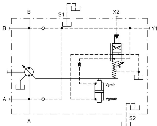
La relazione tra il senso di rotazione dell'albero del motore SH7VR e la direzione del flusso è illustrata in figura
