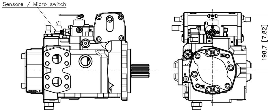
V1: Strozzatore variabile / Adjustable throttle valve
