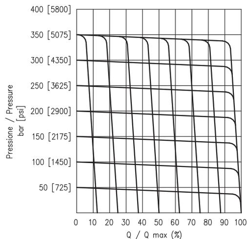
La cilindrata della pompa é variabile agendo sul volantino esterno. La posizione standard del regolatore é (1) ( $V_{g_{max}} - V_{g_{min}}$ ) ma la posizione (2) ( $V_{g_{min}} - V_{g_{max}}$ ) é disponibile a richiesta.
